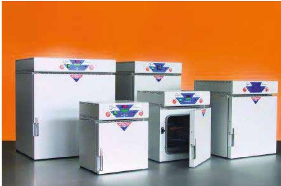
Queste apparecchiature sono tra le più diffuse nel campo della ricerca biologica e chimica. Trovano però applicazioni anche nell'industria, quando è necessario fare un trattamento termico a basse temperature e con ottima uniformità. Sono disponibili sia con ventilazione forzata sia naturale. Le temperature di lavoro degli incubatori va da 0 a 90°C, quella delle stufe da temperatura ambiente fino a 600°C.
