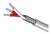
Conduttori: multitrefolo twistati Isolamento: in PVC (- 15/ + 105°C) Schermato con treccia di rame stagnato Diametro dei conduttori: 0,61 mm (24F AWG)
